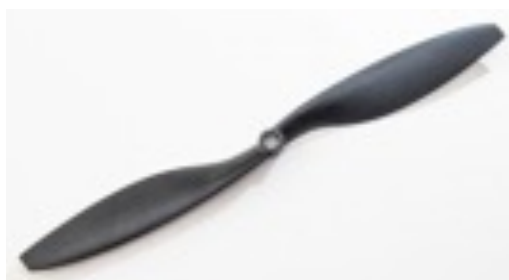
Figura 12. Hélice ReadyTosky 1045 fabricadas en ABS. Fuente: Elaboración propia
