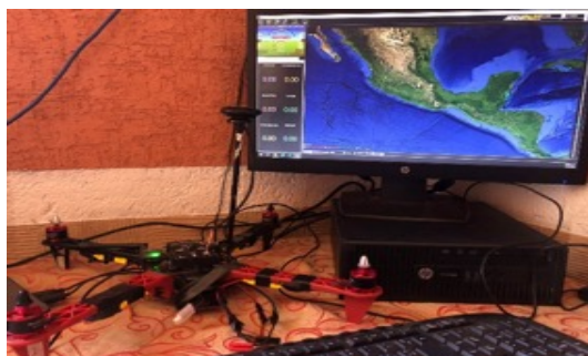
Figura 24. Software Mission Planner, calibración del dron. Fuente: Elaboración propia
