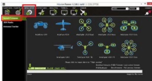
Figura 22. Software Mission Planner, descarga del firmware al Pixhawk. Fuente: (Ardupilot.org, 2025)
