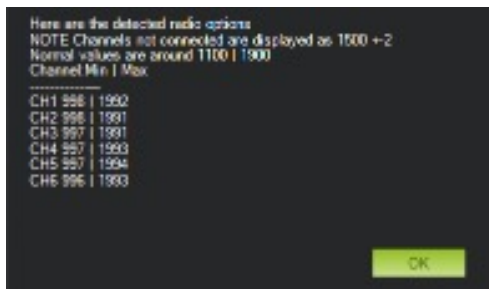
Figura 28. Finalización correcta de calibración del Radio control. Fuente: Elaboración propia
