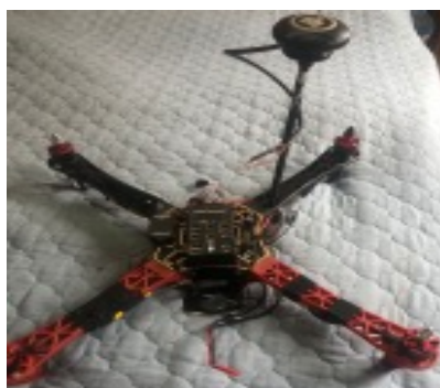
Figura 20. Dron con el controlador pixhawk y el gps en su mástil. Fuente: Elaboración propia
