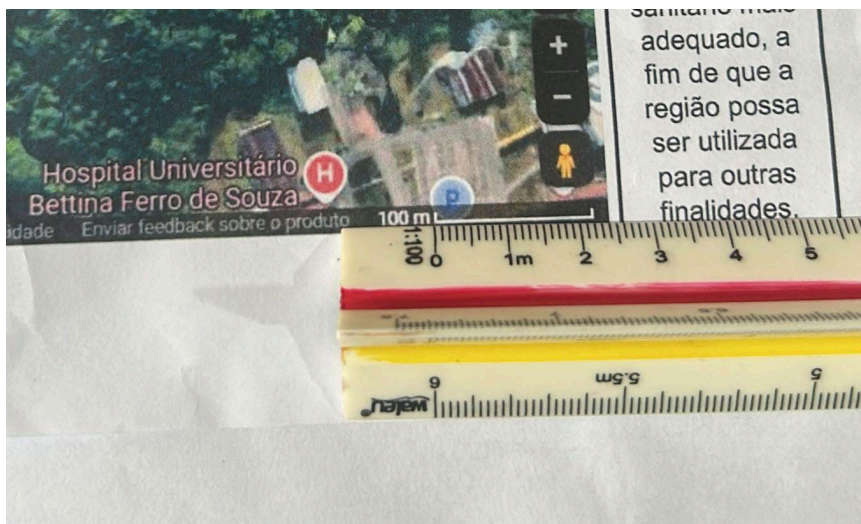
Figura 1: Medida de 2,25 cm no escalímetro utilizada para os cálculos das respectivas áreas:
